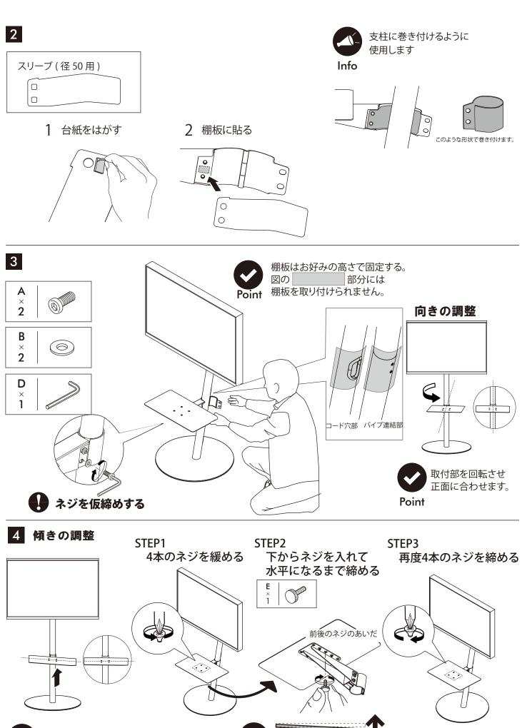
下がっている方の板の下から ネジを入れて調整します。 **Point**
