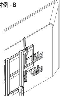
大型テレビ用金具 ネジ穴の縦幅 30cm の場合
