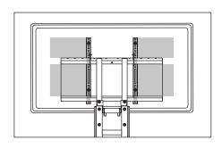
●ご使用のテレビ仕様(重量・重心)と本製品取付位置によっては、 全体の重量バランスが悪くなり、スタンドの安定性に影響します。 (小型の軽量テレビをご使用の際は、ラックの取付位置を低めに するなどの対応をお願いします。)
