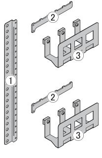
※出荷時に(3)にはネジが取り付けられています。 付属部品 A と共通ネジ
